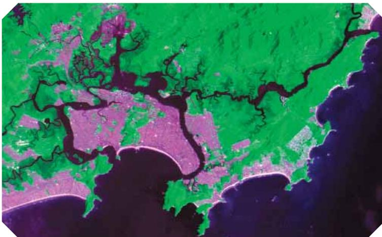
**Figura 13:** Imagem obtida pelo sensor CCD, a bordo do satélite CBERS-2, com resolução espacial de 20 metros. Ela representa a região da Baixada Santista. (INPE)
