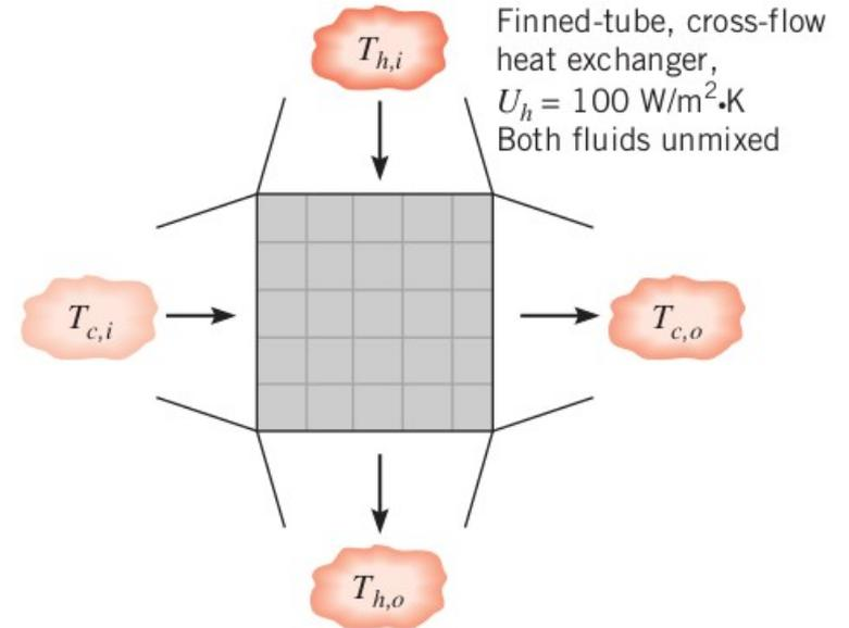
$$U := 100 \frac{\text{W}}{\text{m} \cdot \text{K}} \quad A := 40 \text{ m}^2$$
