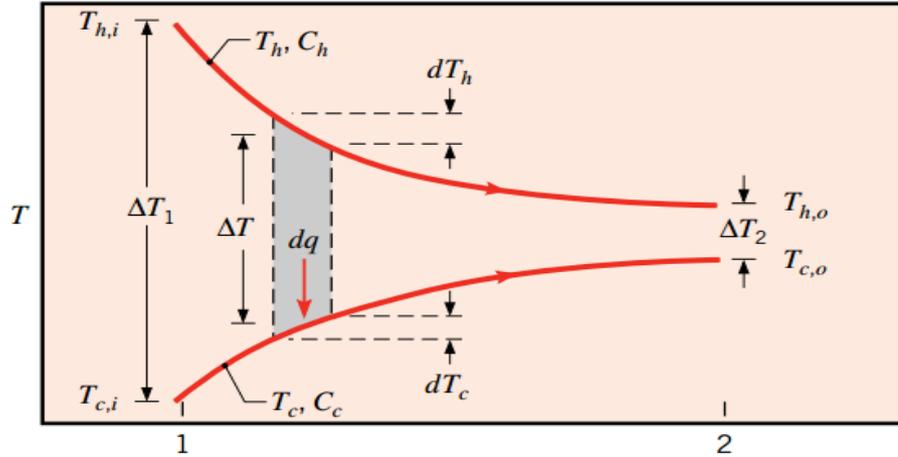
O resultado similar ao transferência de calor entre o fluido escoando e uma superfície com temperatura constante
