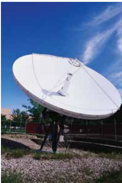
Uma antena parabólica reflete sinais para o foco de um parabolóide.
